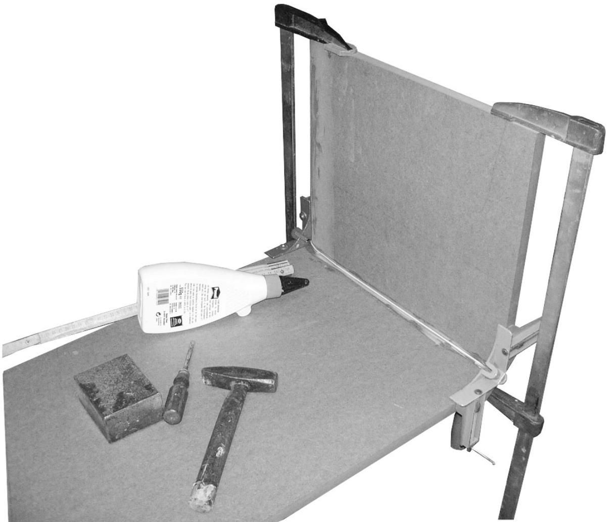
4. Danach hobeln Sie von der Bodenplatte vorn die 20 Grad Schräge ab und verleimen diese stirnseitig mit der Rückwand und der Seitenwand.
